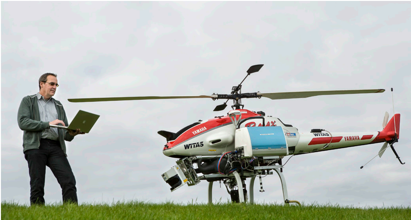
I WITAS-projektet konstruerades en helikopter som kunde manövrera i luften utan förare. På bilden Patrick Doherty med obemannad helikopter.
