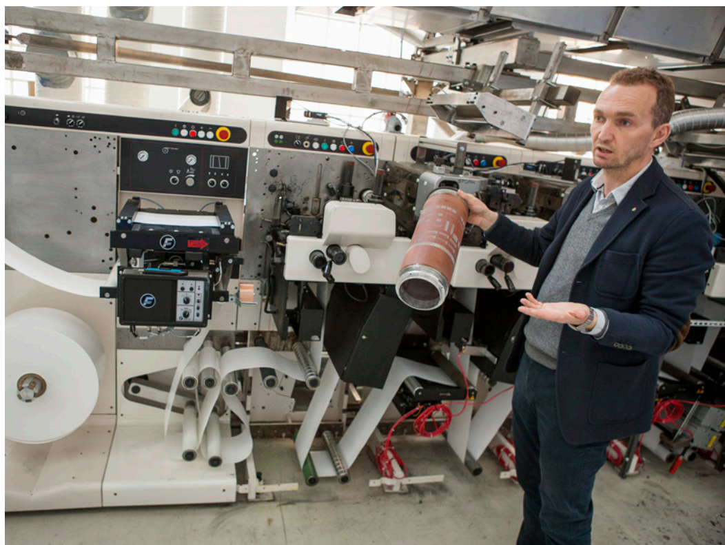
En vanlig tryckpress har omvandlats till en som trycker elektroniska komponenter på papper. I de behållare som är ämnade för tryckfärg hålls elektroniskt bläck. Magnus Berggren demonstrerar.
