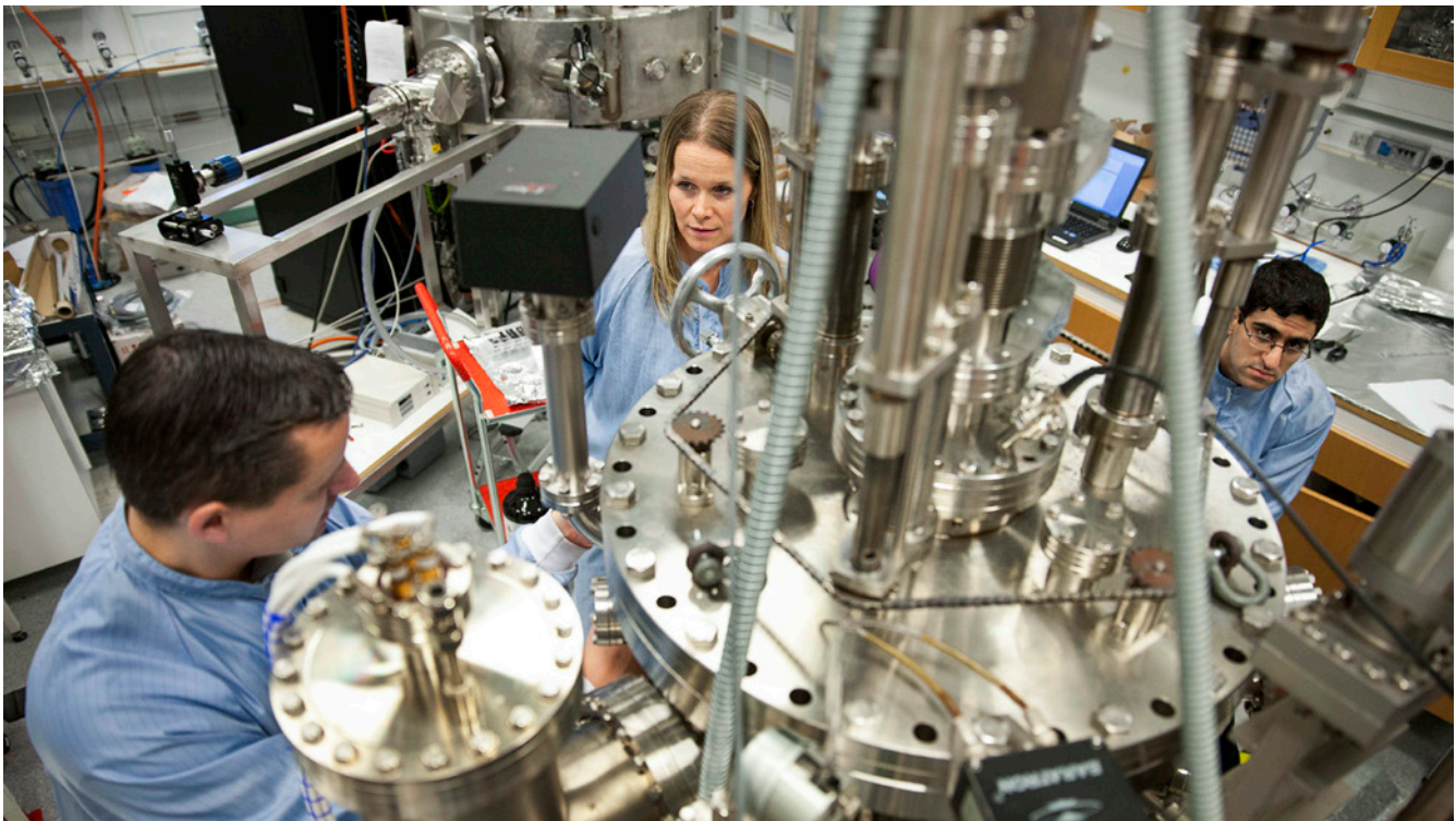
Johanna Rosén och hennes kollegor har designat och byggt tre vakuumkanmare för att kunna tillverka de MAX-faser och nanolaminat som de modellerat i datorn.
